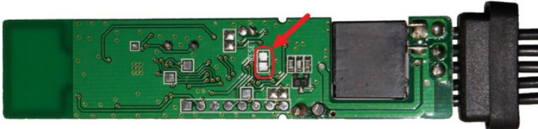
2. на 10 секунд подайте питание на реле. После отключения питания разомкните контактные площадки — теперь его снова можно записать в память автосигнализации.
