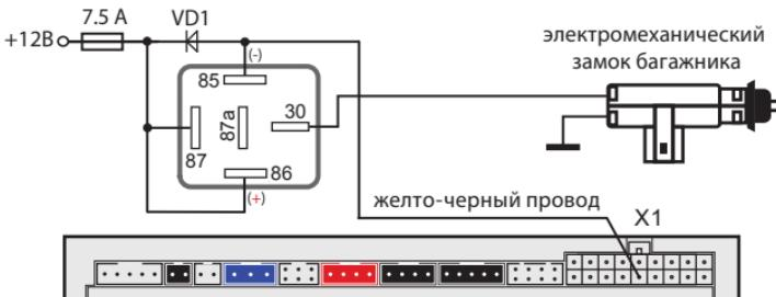
При подключении необходимо использовать дополнительное реле, а для функция 13 таб. №1 следует выбрать вариант 1 (см. стр. 57).
