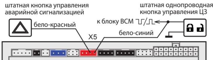
Выходы альтернативного управления активируются автоматически (после записи в память автосигнализации номера, соответствующего Вашему автомобилю). Активный управляющий уровень может быть как положительным, так и отрицательным (в зависимости от модели автомобиля). Предельно допустимый ток нагрузки на выходе – 200 мА. Информацию о возможности альтернативного управления и способах подключения Вы можете найти на странице [can.starline.ru](http://can.starline.ru)
