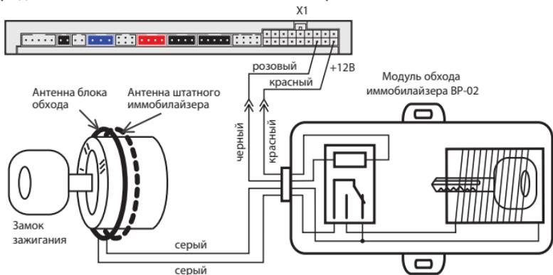
Если требуется подключить модуль обхода в разрыв антенны штатного иммобилайзера, рекомендуем использовать эту схему включения:
