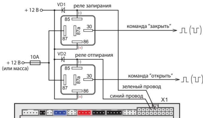
**Подключение к двухпроводным приводам системы запирания**
